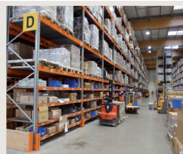
Nella seconda modalità di stoccaggio, i prodotti piccoli ad alto tasso di rotazione sono immagazzinati su scaffali nella zona inferiore. Quando il raccogliatore prende l'ordine, il palmare gli mostra la posizione di ogni pezzo e il suo percorso è definito per essere il più facile e veloce.
